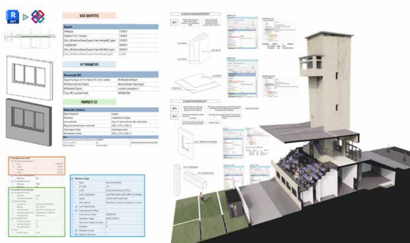
Fig. 6 - Il processo Scan2-openBIM ha permesso di esportare gli elementi codificati del modello 3D in formato IFC secondo i parametri geometrici del modello (BaseQuantities), i parametri informativi (IFC Parameters) e gruppi di proprietà personali (PropertySet).
