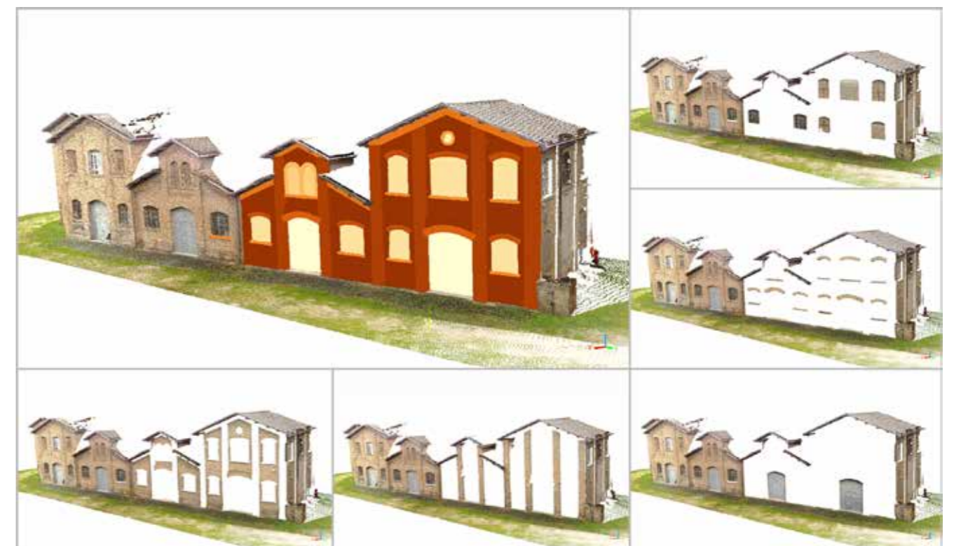
Fig. 6 - Nuvola di punti segmentata all'interno del software Cloud Compare, dove è possibile isolare e individuare i diversi elementi identificati.
