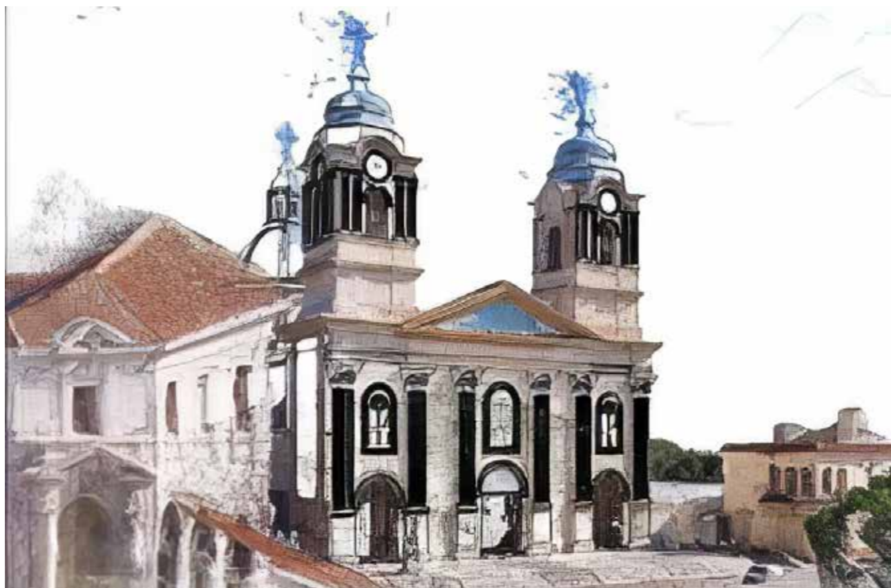
Fig. 1 - Nube de puntos y modelo BIM superpuesto de la Basílica Menor de Nuestra Señora del Rosario. Fuente: Archivos del equipo de trabajo 2017.
