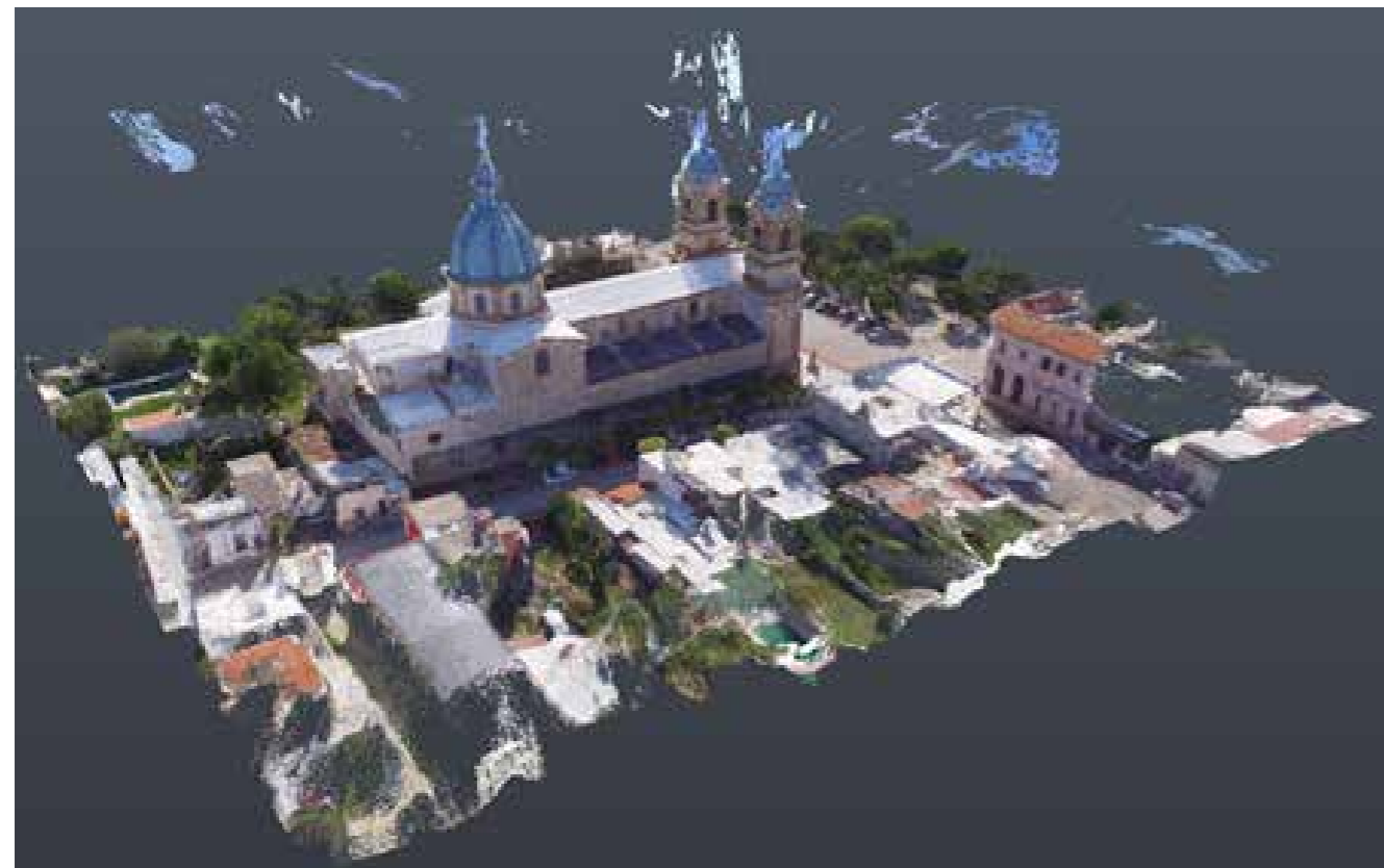
Fig. 6 - Entorno a partir de nube de puntos. Imagen desde Autodesk Recap. Fuente: Archivo del equipo de trabajo 2017.
