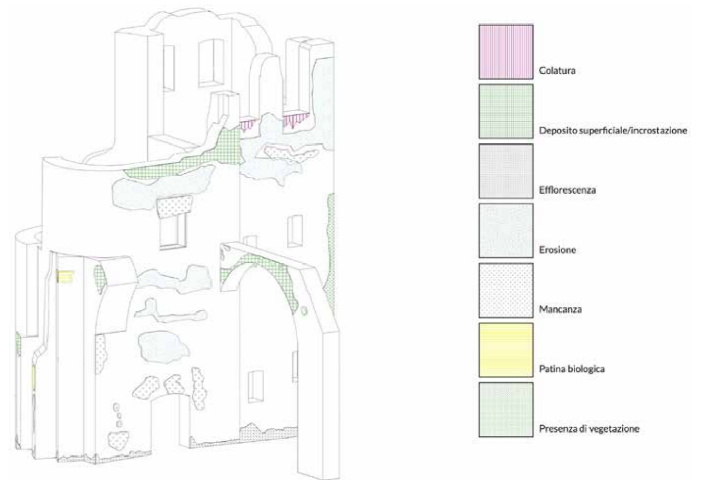
Fig. 6 - Modello parametrico con mappatura del degrado, formato .ifc.
