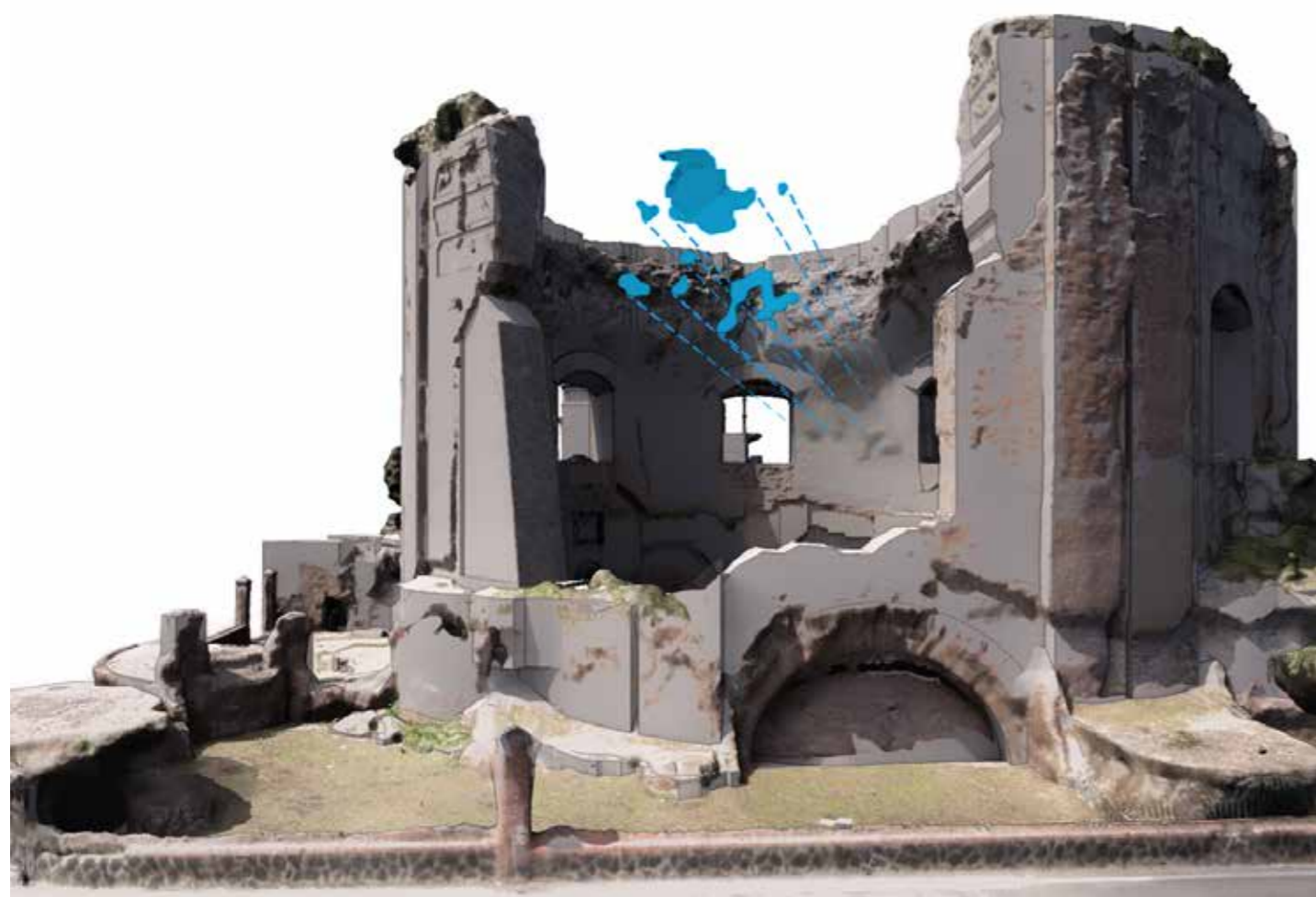
Fig. 8 - Photobashing del processo di modellazione: dal modello discreto e continuo del rilievo alla rappresentazione BIM e sperimentazione di modelli adattativi per la riproduzione dei 'segni' degradati del tempo (elaborazione propria).
