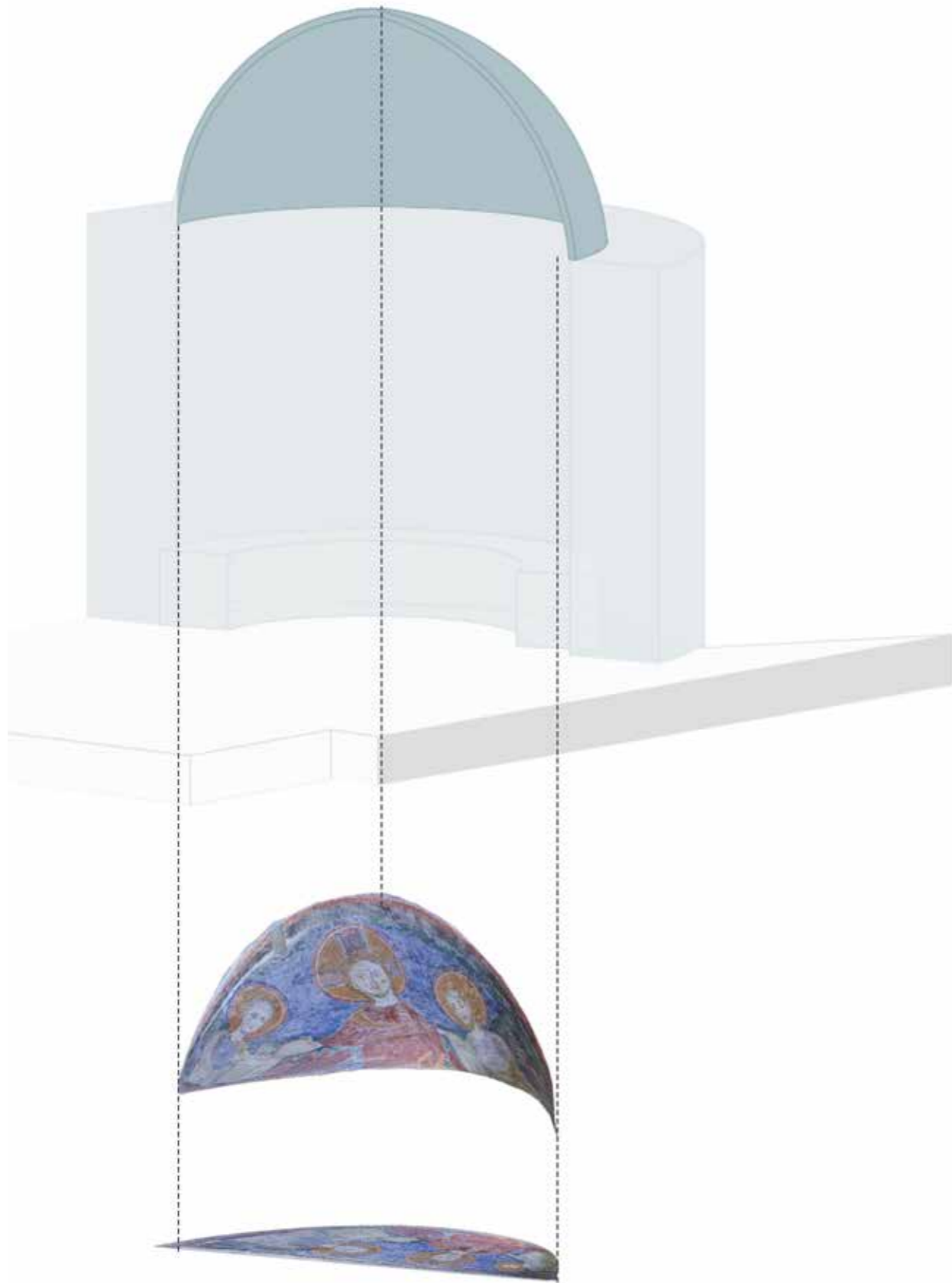
Fig. 5 - Proyección del ortomosaico sobre una semicúpula- Fuente: Elaboración propia.
