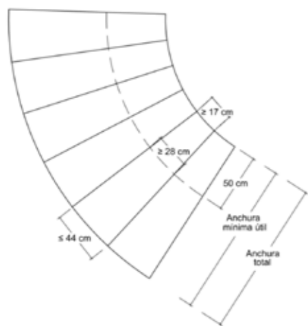
Fig. 3 a. - Detalle de la planta de la escalera con tramo curvo [CTE DB-SUA 1. Art. 4].
