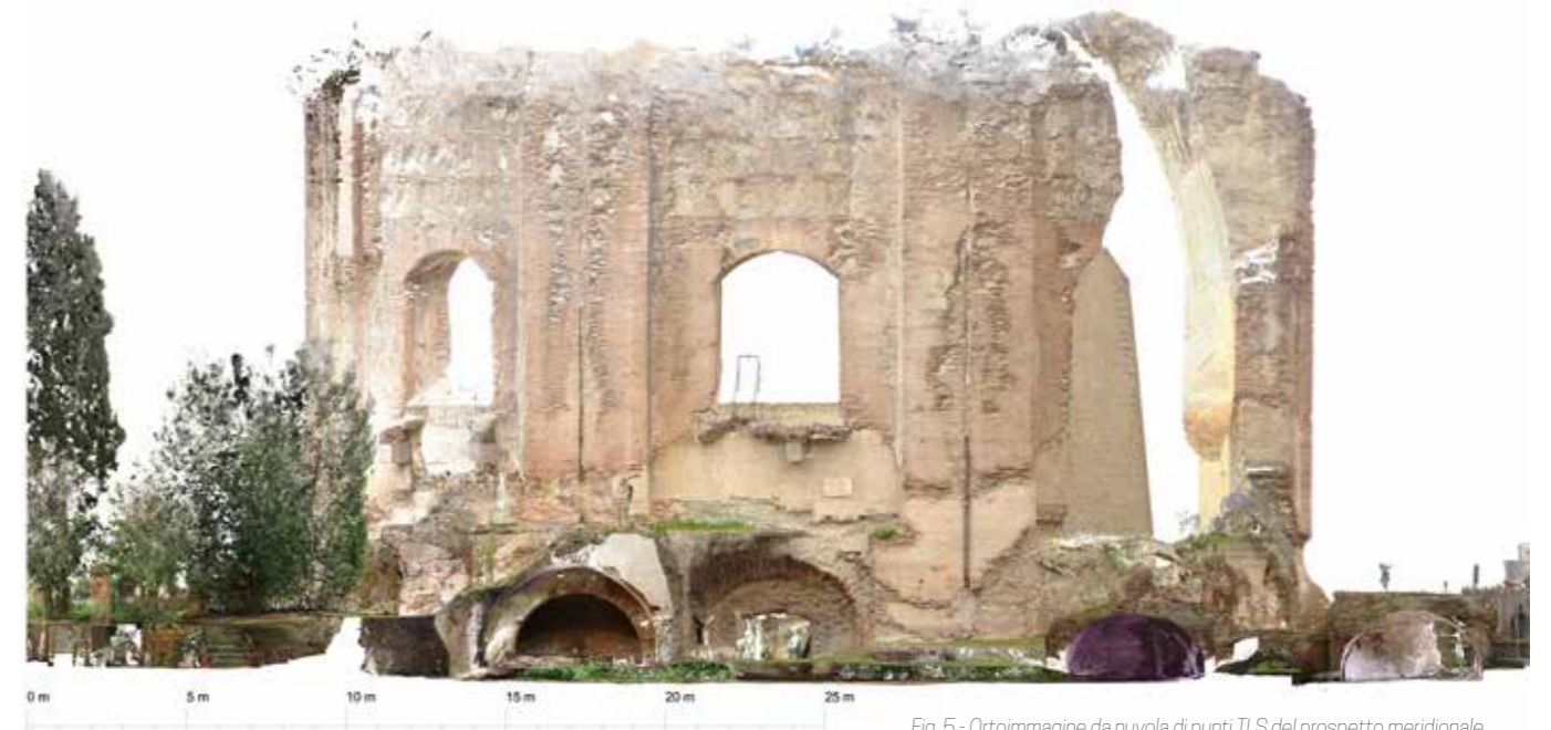
Fig. 5 - Ortoimmagine da nuvola di punti TLS del prospetto meridionale del c.d. Tempio di Venere (elaborazione propria).
