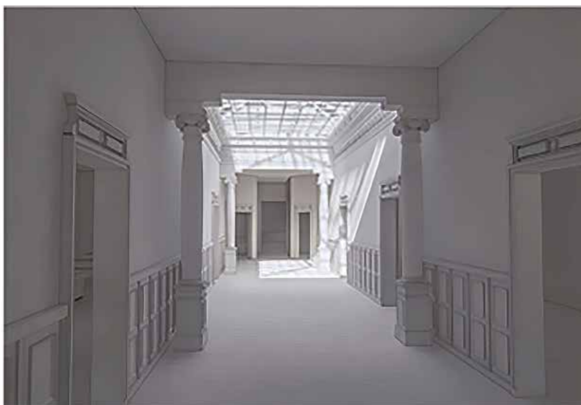
Fig. 8 - Vista en perspectiva de la nube SLAM en el mapa de reflectancia y vista renderizada desde el modelo.
