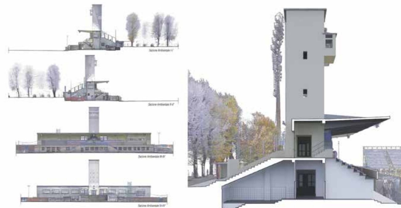
Fig. 4 - Attraverso l'uso di metodologie di documentazione integrata, si sono potuti sviluppare disegni bidimensionali altamente affidabili per comprendere le relazioni architettoniche tra gli elementi dell'impianto sportivo.
