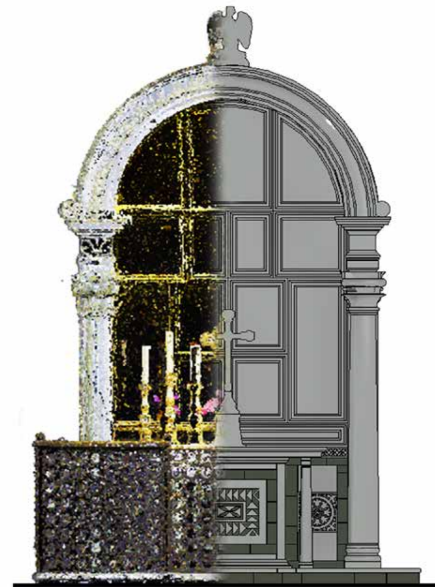
Fig. 4 - Configurazioni dei modelli 3D digitali ottenuti con le diverse metodologie di acquisizione.
