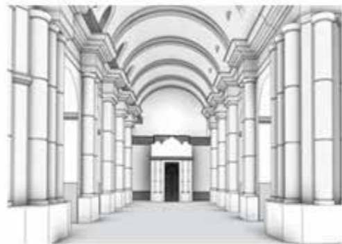
Fig. 14, 15, 16, 17. - Trabajo en proceso, modelado interior y exterior mediante el uso de familias paramétricas para representar molduras a través de perfiles. Fuente: Archivo del equipo de trabajo 2017.
